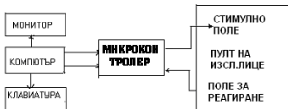
Фиг. 1. Блок-схема на компютърна система за психологически контрол
